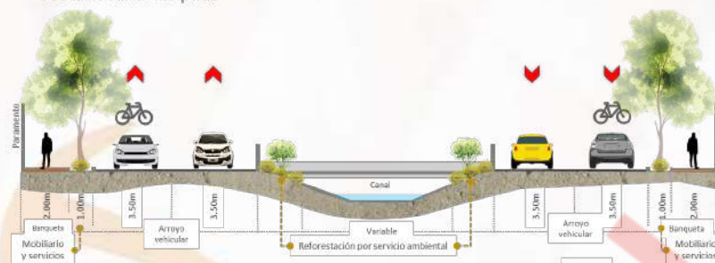
Imagen 92. Sección vialidad Secundaria 20m.
